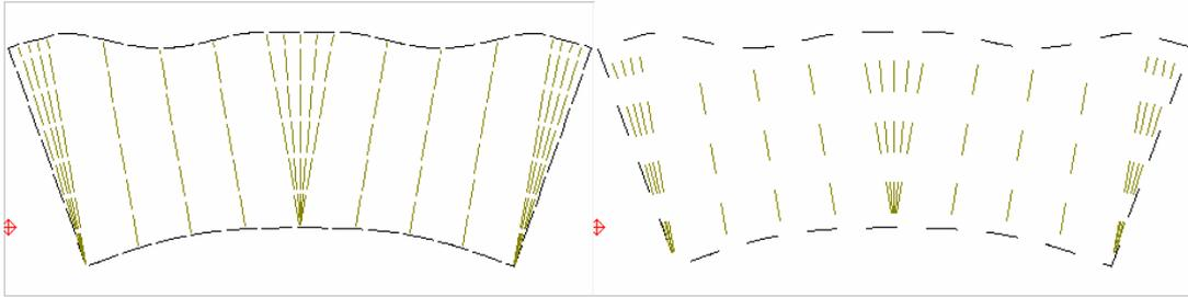
So werden z.B. die Abwicklungen mit den Längen der Striche =2 mm und 10 mm aussehen:
